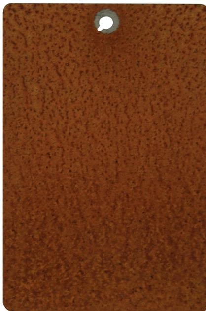
Stahl-Korrosionsmessprobe auf freiliegender Verkleidung mit geringerer Oberflächenkorrosion.
