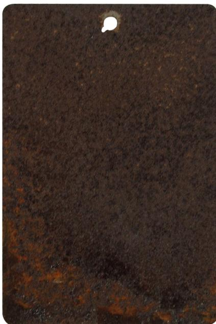
Stahl-Korrosionsmessprobe unterhalb von PV-Modulen mit starkem Rotrost und Ablätterungen.
